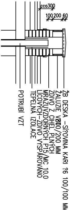
VZOROVÝ ŘEZ VĚTRACÍ ŠACHTOU 1:25
