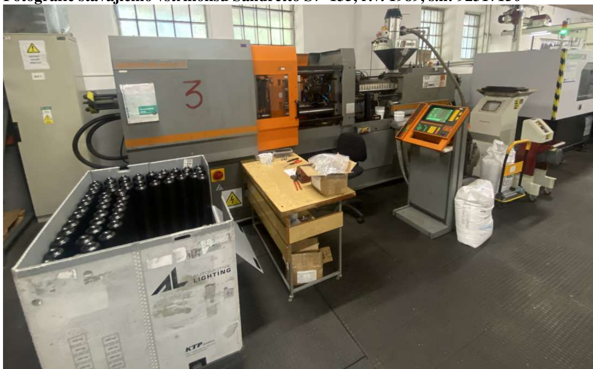
Fotografie stávajícího vstřikolisu Sandretto S7 135, r.v. 1989, s.n: 92317150
