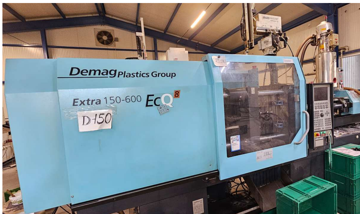
Fotografie stávajícího vstřikolisu Demag Extra 150-600, r.v. 2007, s.n: 7887-1010
