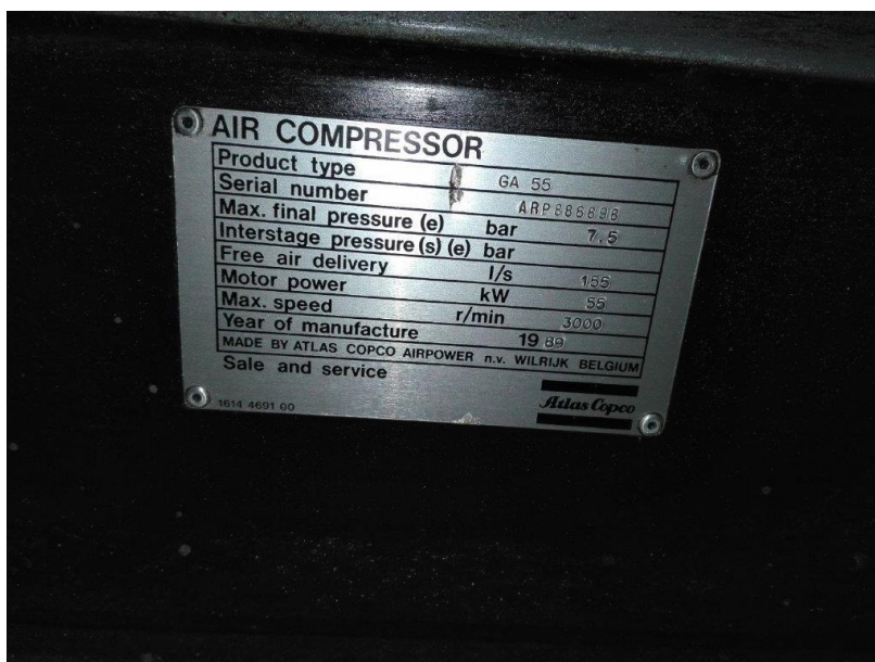
obrázek 3 Kompresor Atlas Copco GA 55- výrobní štítek
